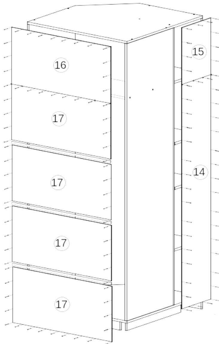
**Рис.5 - Монтаж задних стенок на стыке
