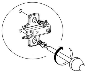
**Рис.8 - Монтаж чашки петли 21а на фасад**
