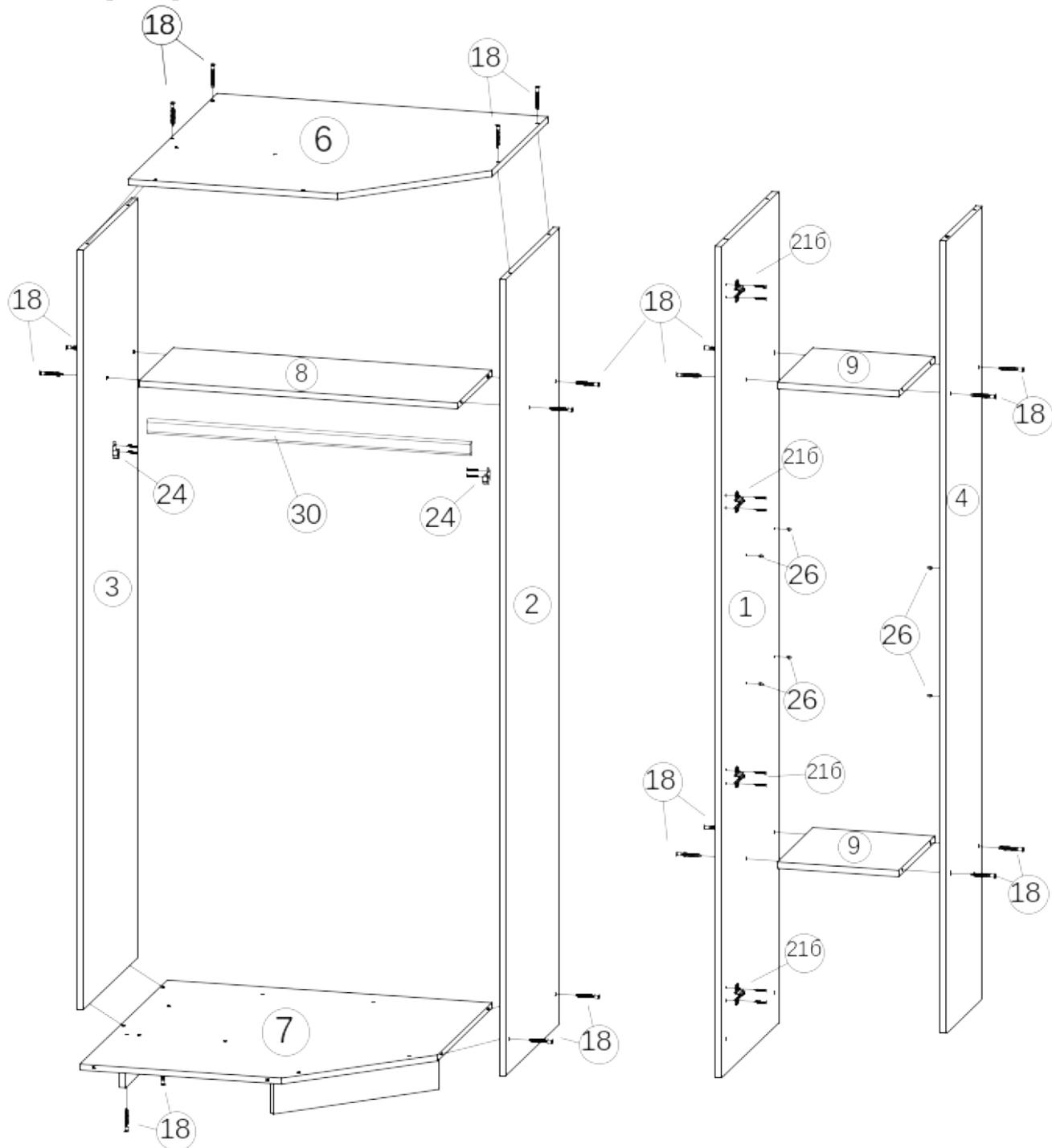
5. Соедините получившиеся две конструкции между собой, прикрутив перегородку(4) к Крыше(6) и Вязке(7), а Боковину(1) к Вязке(7) евровинтами(18)(см. рис.3).
