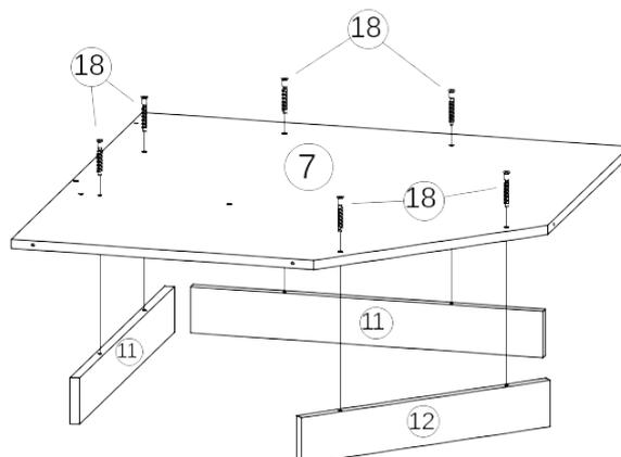
3. Соедините Правую боковину(2) и Заднюю стенку(3) с Крышей(6) и Вязкой(7) при помощи евровинтов(18).
